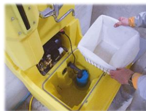
Filtersystem, Tauchpumpe und Hochdruckpumpe
