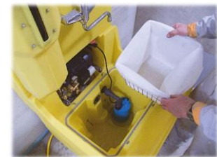
Filtersystem, Tauchpumpe und Hochdruckpumpe
