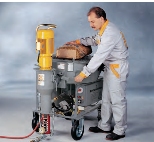
Materialbehälter und Mischrohr sind voneinander getrennt. Sie öffnen den Schieber und das Trockenmaterial gelangt ins Mischrohr.
