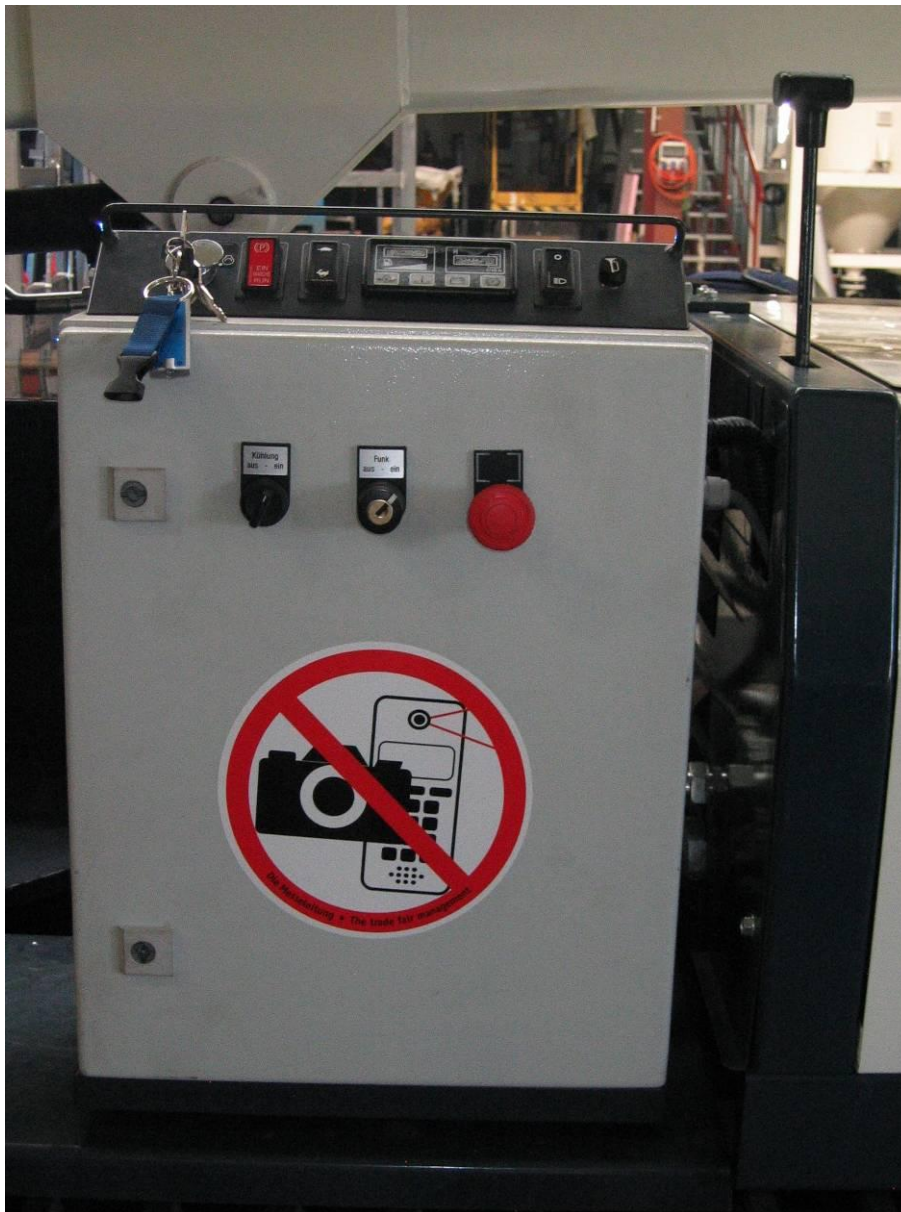
Bild 5-1: Bedienkonsole mit Schaltschrank und Gashebel
