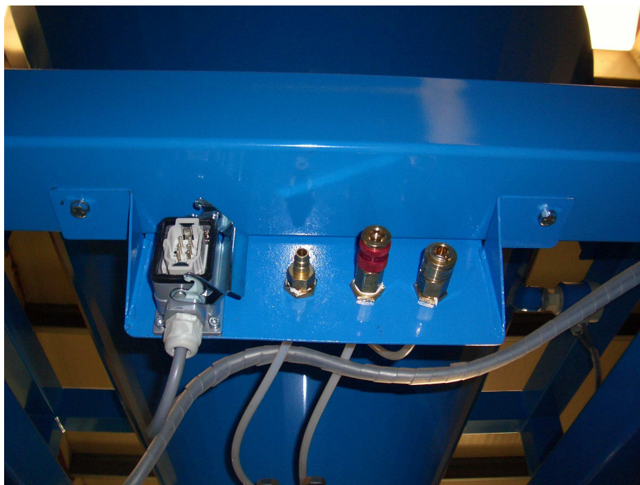
Bild 3-3: gezogene Stecker an dem abnehmbaren Vorsilo
