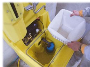
Filtersystem und Tauchpumpe
